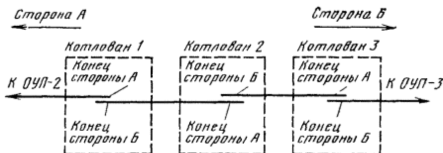
Рис. 8.2. Обозначение концов кабеля в котловане
