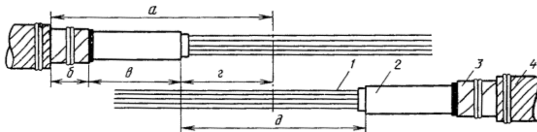
Рис. 8.12. Размеры разделки концов кабеля в свинцовой оболочке:
