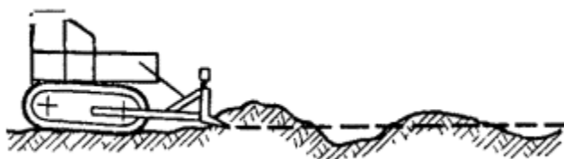
Рис. 5.1. Планировка трассы бульдозером.
