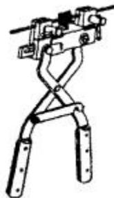
Рис. 8.32. Сварка стальных проводов
