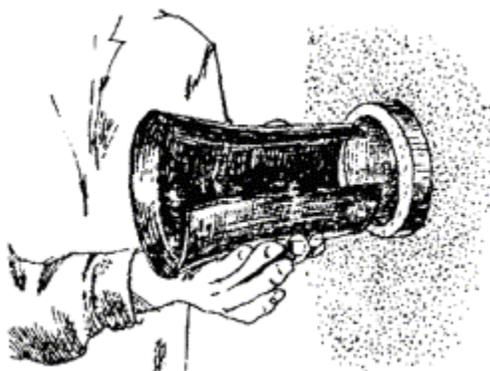
Рис. 4.14. Установка воронки в трубу канала
