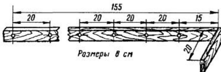
Рис. 8.7. Шаблон разметки отверстий в столбе для ввертывания крюков
