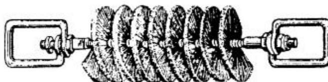
Рис. 4.4 б. Щетка для прочистки канала
