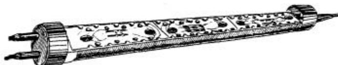
Рис. 12.10. Разветвительная муфта после сварки и выкладки ОВ
