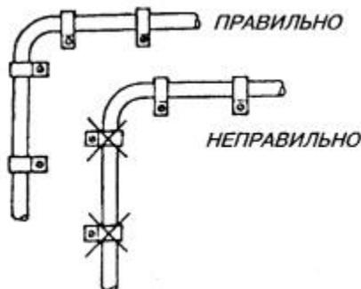
Рис. 7.29. Крепление кабеля при изменениях направления трассы
