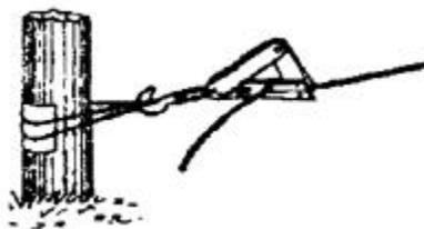
Один конец проволоки зажать в блочную лапку, которую при помощи петли или хомута закрепить у основания опоры
