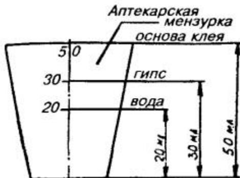
Рис. 7.24. Пропорции компонентов для составления клея «Стык-10»
