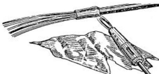
Рис. 12.11. Продольная герметизация кабеля термоусаживаемой трубкой
