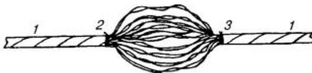
Рис. 11.9. Распушивание пучка в «фонарик»:
